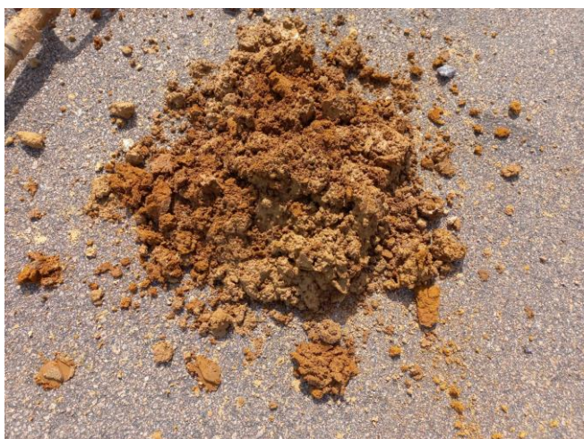
Foto 5 - Aterro cascalho laterítico argiloso
